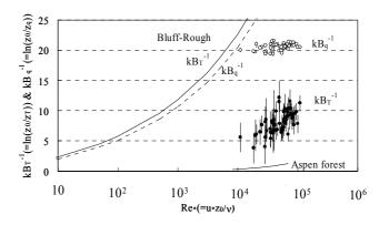
図-2 スカラー粗度と摩擦レイノルズ数. 誤差バーは 放射温度を±1℃変化させたときの影響範囲を示す.
